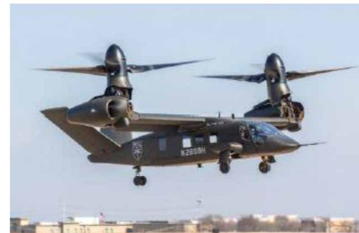
شکل ۲- هواپیمای روتور-چرخان V-280 در وضعیت عمودپرواز [۲]
