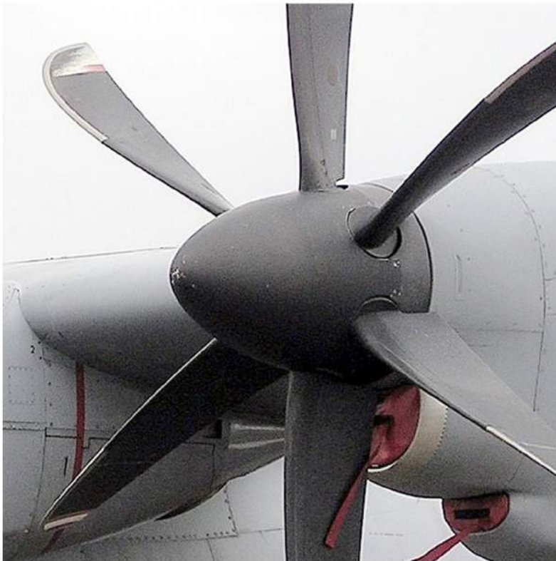
شکل ۵ - چرخش پره‌ها از ریشه این امکان را فراهم می‌کند که هنگام توقف نیروی درگ زیادی ایجاد شود.
