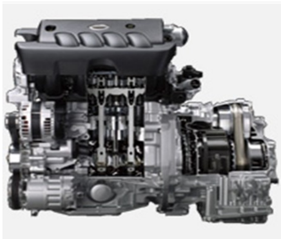
شکل ۴ موتور با انتقال قدرت پیوسته ساخت شرکت آئودی
