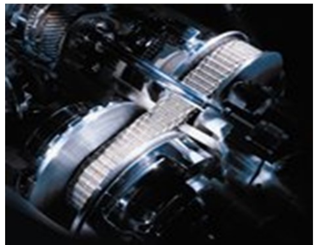
شکل ۳ انتقال قدرت پیوسته مبتنی بر قرقره
