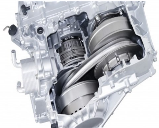
شکل ۲- الف سیستم انتقال قدرت پیوسته
