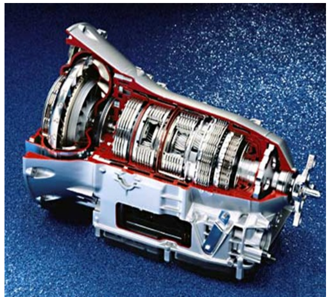
شکل ۲- ب گیربکس اتوماتیک
